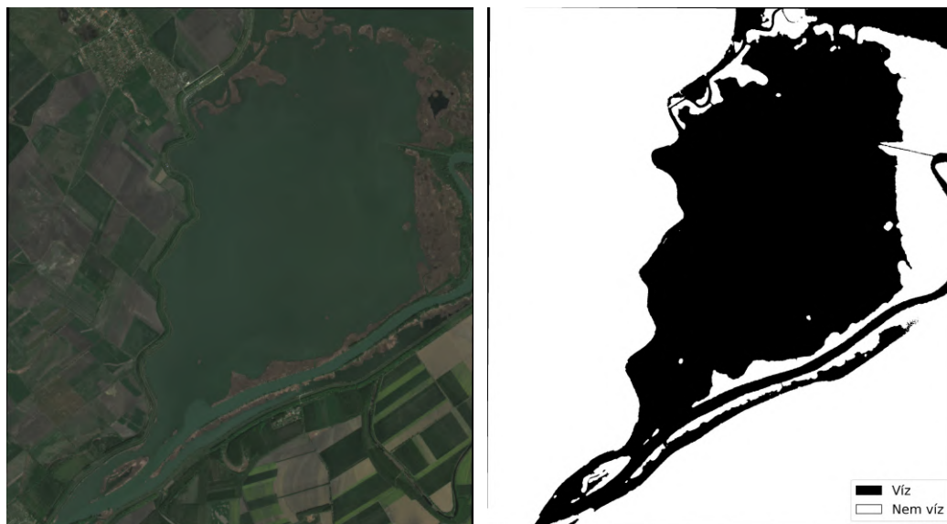
5.1. ábra. PlanetScope tesztfelvételének eredeti képe (bal oldal) és a vízmaszkja A vízmaszk a 2019.04.21.-ei felvételre készült a GRVI indexből a Minimum algoritmus által meghatározott küszöbértékkel.
