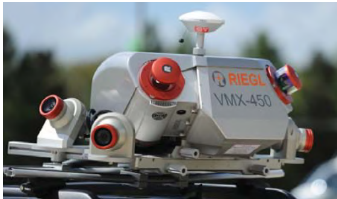
2.2. ábra. Riegl VMX-450 mobil lézerszkennelő rendszer. Forrás: [18]
