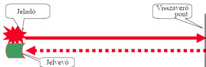
1.1. ábra. LiDAR működési elve. Forrás: [3]
