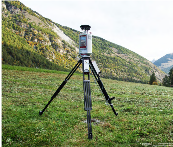
1.4. ábra. Földi lézerszkennelés. Forrás: [6]
