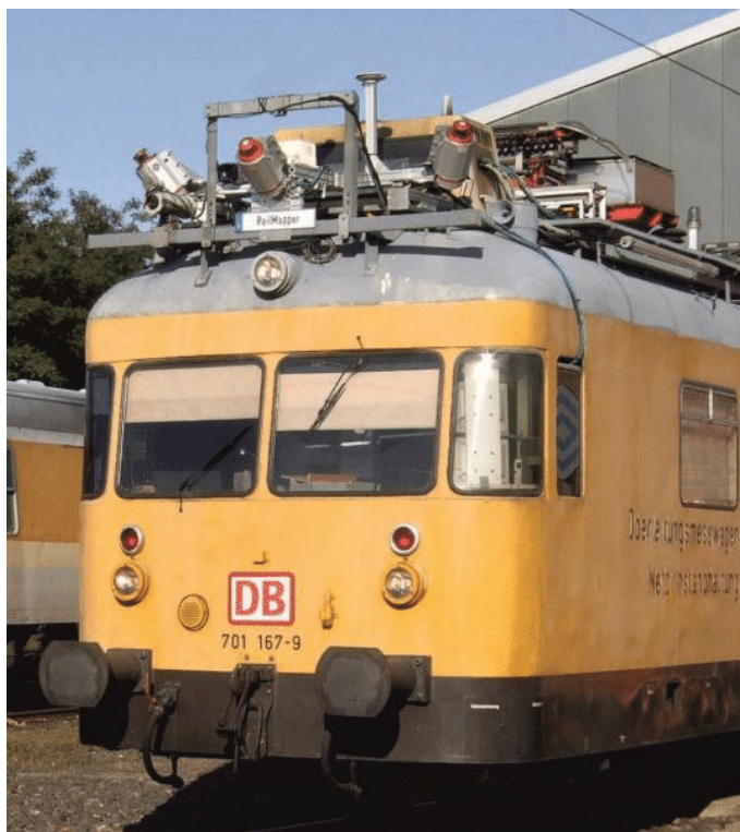
1.3. ábra. Mobil lézerszkennelés vasúttal. Forrás: [5]
